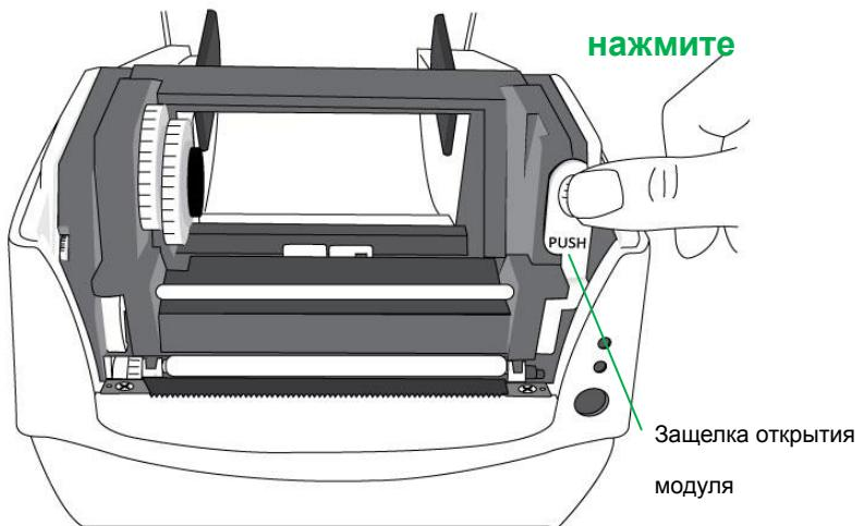
3. Откиньте модуль принтера для проверки держателя подачи риббона.
