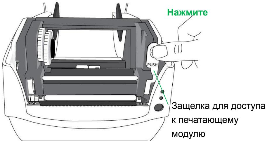
5. Протяните небольшое количество носителя под опорным валиком принтера.
