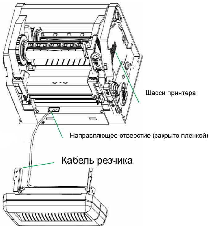
8. Установите обратно шасси принтера и среднюю крышку.
