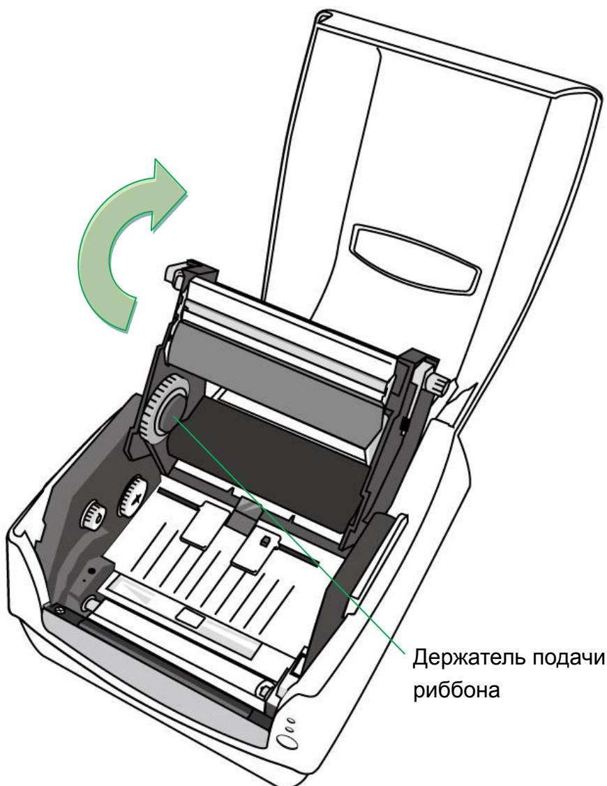
4. Установите один ролик с риббоном и вращайте его до выравнивания пазов, затем закрепите его вначале слева, затем справа.
