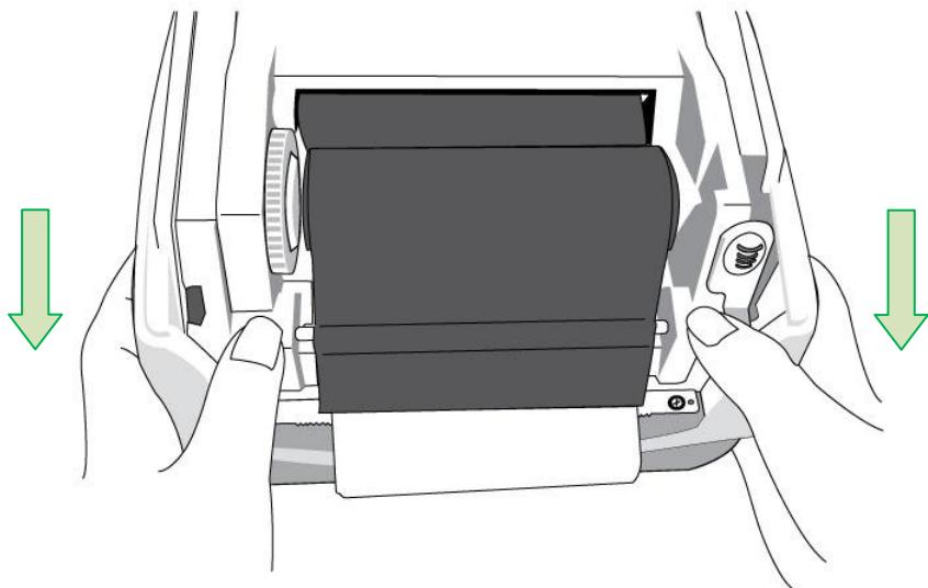
7. Поверните колесико держателя использованного риббона для удаления провисания риббона и возможных морщин и закрепите ленту на шпиндельях.
