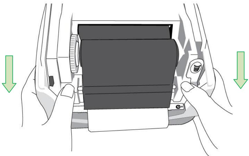
8. Нажмите на кнопку протяжки до выхода этикетки из принтера
