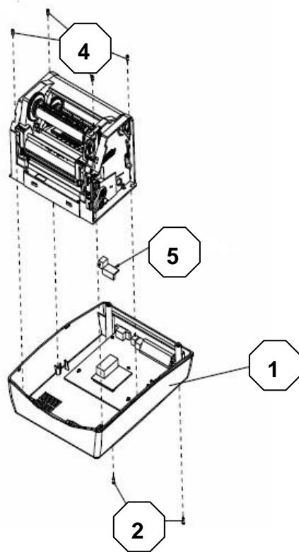
7. Снимите пленку с шасси принтера. Проденьте кабель от резчика через отверстие, на котором была пленка, и присоедините ее к разъему JP9 (РЕЗАК) на главной плате принтера. Кабель резчика должен проходить через крючки под шасси принтера для наибольшей совместимости.
