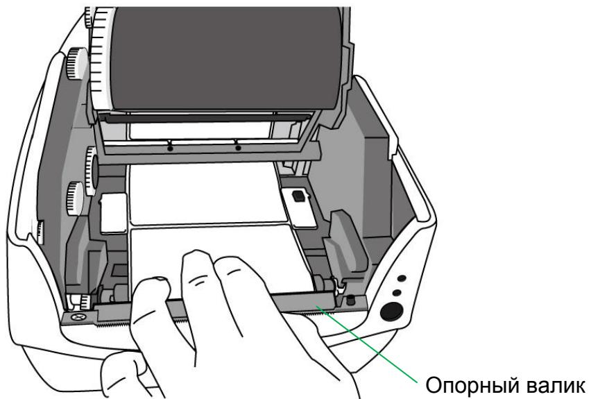
6. Нажмите на замок правого из двух направляющих носителя и сдвиньте их для плотного прилегания.
