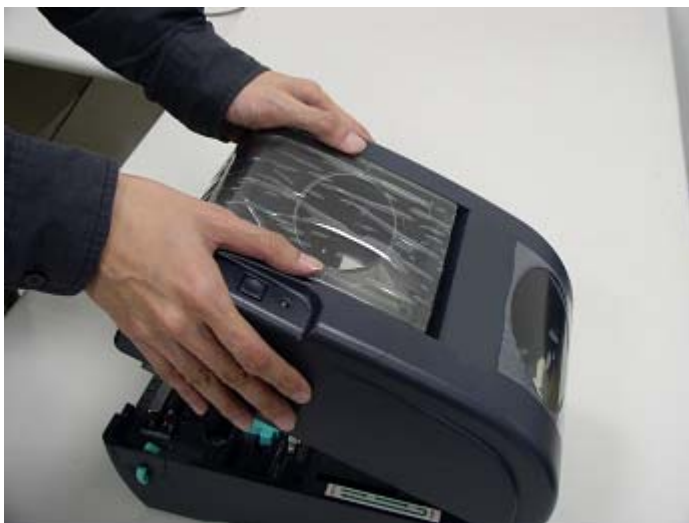
Рис. 3. Закрывайте верхнюю крышку двумя руками
